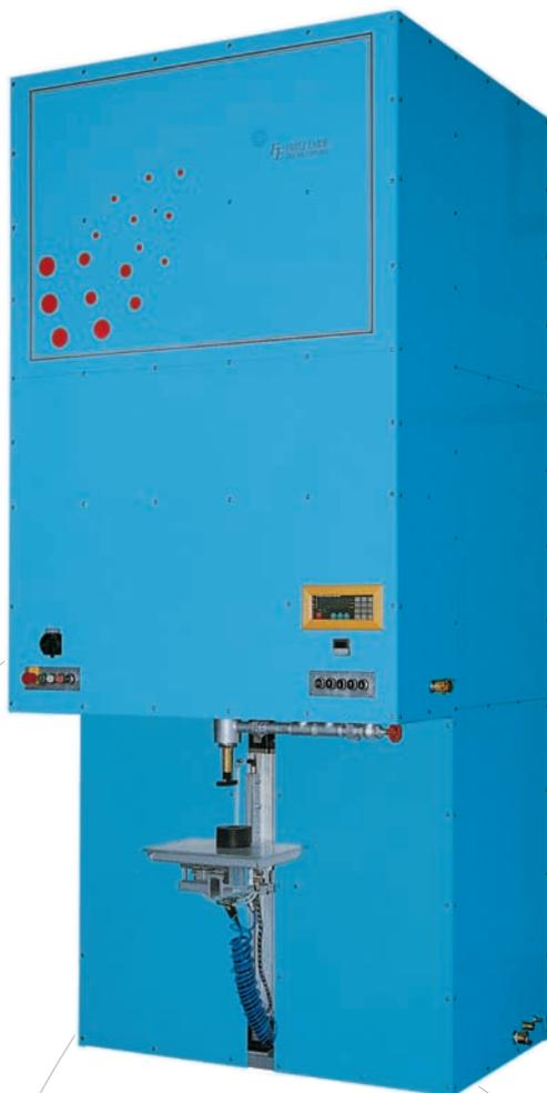
DSM – La estación de llenado de extintores estacionaria, completamente automatizada, controlada por un autómata programable, ofrece un rendimiento excepcional y destaca en los siguientes conceptos:
